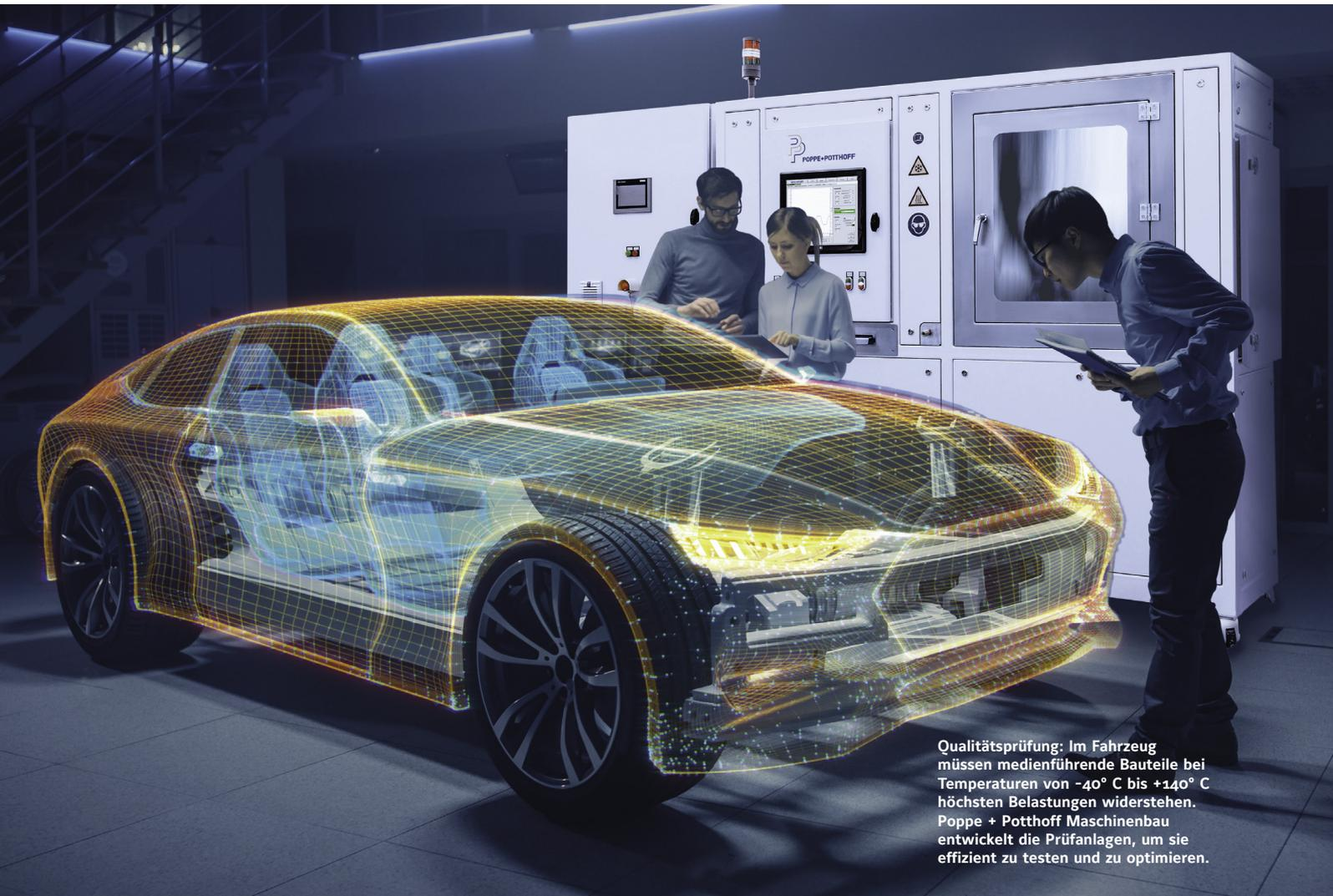
Qualitätsprüfung: Im Fahrzeug müssen medienführende Bauteile bei Temperaturen von  $-40^{\circ}\text{C}$  bis  $+140^{\circ}\text{C}$  höchsten Belastungen widerstehen. Poppe + Potthoff Maschinenbau entwickelt die Prüfanlagen, um sie effizient zu testen und zu optimieren.
