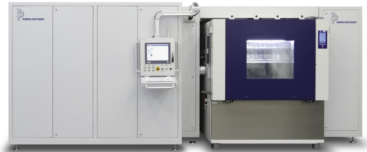
Druckwechselprüfstand mit Klimakammer
