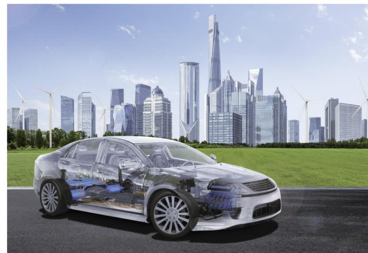
Traktionsbatterie: Sie sorgt nicht nur für den Antrieb, sondern versorgt auch die gesamte Elektrik des Fahrzeugs mit Strom. Im Funktionsprüfstand von Poppe + Potthoff Maschinenbau lässt sich die Energieeffizienz der Heiz- und Kühlaggregate prüfen und optimieren, um die Leistungsfähigkeit des Akkus zu steigern.
