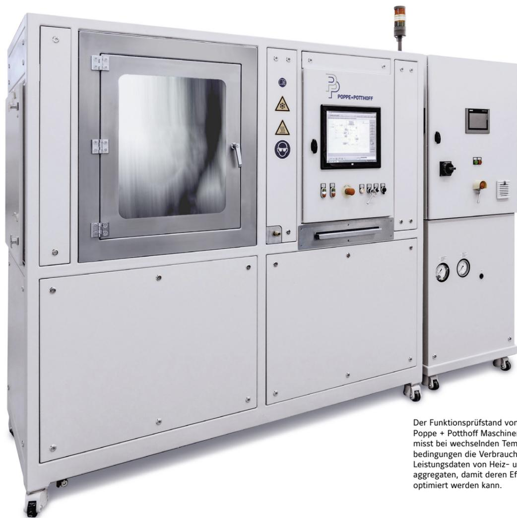
Der Funktionsprüfstand von Poppe + Potthoff Maschinenbau misst bei wechselnden Temperaturbedingungen die Verbrauchs- und Leistungsdaten von Heiz- und Kühlaggregaten, damit deren Effizienz optimiert werden kann.
